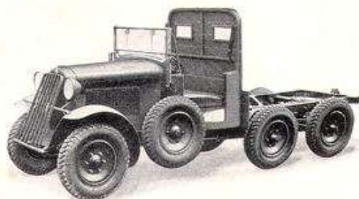
Fahrgestell des geländegängigen Steyr Sechsrads-Wagens Typ 640 mit Vorderkotflügel, Motorhaube, Windlaufgruppe und zweisitzigem Führerhaus (letzteres ohne Verdeck). Als Plateauwagen karrossiert für eineinhalb Tonnen Nutzlast, auch als Mannschaftswagen verwendbar, für vierzehn Mann einschließlich Fahrer und Mitfahrer.
